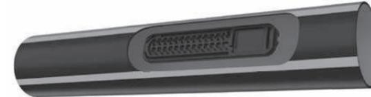
新開発のターボネクスト構造ドリッパーを装着。広い流路でより強い乱流を発生し、目詰まりを軽減します。
