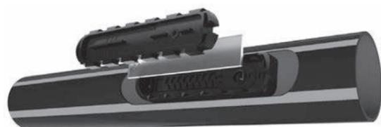
圧力補正および水ダレ防止機構付きのドリッパーを装着した、耐久性に優れたチューブです。灌水および施肥灌水は超均一で、短いピッチ、パルス灌水、傾斜地でも威力を発揮します。圧力維持のメカニズムで水圧がかかっていない時の水ダレを防止します。
