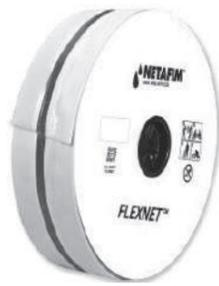
強化ポリプロピレン製のメイン・サブメイン用フレキシブルパイプです。高水圧で使用可能で、大口徑にもかかわらずコンパクトで輸送や保管に便利です。一定間隔でスタートコネクター用の穴(1/2"メスネジ)が開けられているので点滴チューブの接続も簡単です。メイン配管用の穴なしタイプもあります。
