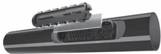
圧力補正、吸い込み防止機構付きの地中灌水に最適なドリップチューブです。傾斜地でも吐出量が均一で、根が侵入しにくくなる酸化銅を含む素材を使用しています。耐久性に優れ、傾斜のある圃場などにも適しています。
