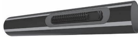
新開発のターボネクスト構造ドリッパーを装着。フィルター面積、流路断面積がより広く、流路長が短くなりました。目詰まりの抑制効果がより大きくなり、均一で安定した点滴灌水が長期にわたり可能になります。
