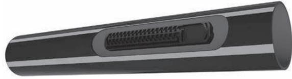
新開発のターボネクスト構造ドリッパーを装着。フィルター面積、流路断面積がより広く、流路長が短くなりました。目詰まりの抑制効果がより大きくなり、均一で安定した点滴灌水が長期にわたり可能になります。吐出量 1.0ℓ / 時の低流量タイプです。
